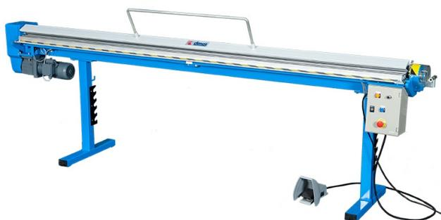
Mit den Biegewangen können Metallbleche mit Durchmessern von 13 bis 25 mm gesäumt werden.
